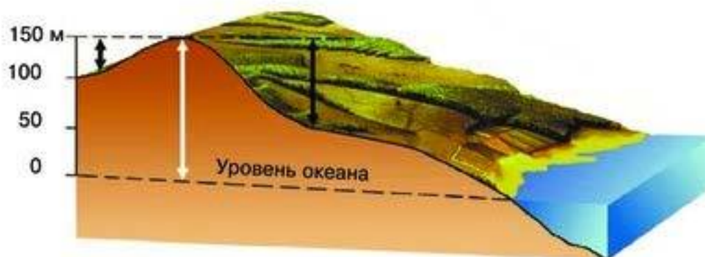
Рис. 11. Относительные высоты холма (тёмные стрелки) и его абсолютная высота (светлая стрелка)
